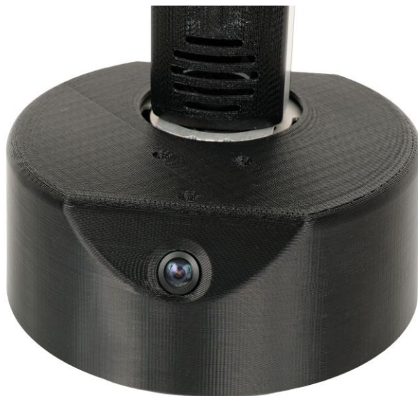
小型コミュニケーションロボット ベースモデル VS-KRM01(内蔵カメラ部分)
